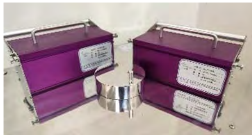
储存铅罐 (高活室, 2 个)
